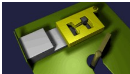
Animacja działania zamka, zasuwę z podtrzymkami (pobrane z WIKIPEDII)
